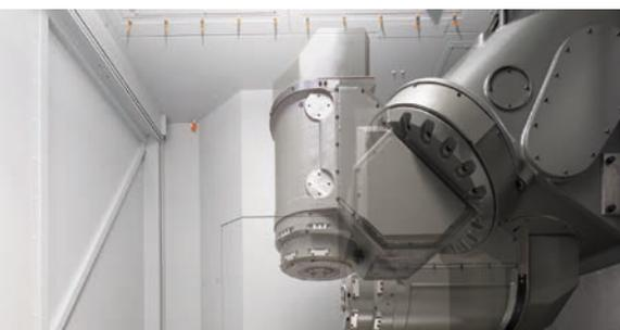
questo è ben chiaro in Toyoda, che punta da sempre su componenti di elevato livello qualitativo. In particolare la vite a ricircolo di sfere, che sui modelli di questa serie è situata al centro dell'elemento simmetrico scorrevole lungo l'asse Y, riduce la deformazione termica provocata dalle variazioni di temperatura e gli squilibri generati dalla forza di gravità, assicurando un avanzamento stabile.
