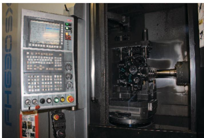
*Il centro di lavoro orizzontale Toyota, modello FH630 SXI, capace di operare su un volume di 1.050x900x1.050 mm*
